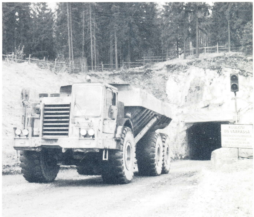
Kuvassa malminkuljetusajoneuvo vinotunnelin suulla.
